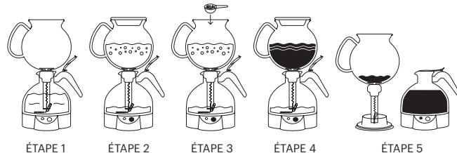
**Remarque :** Si la chambre inférieure est vide, l'appareil ne s'allumera pas : cette mesure de sécurité évite que l'élément chauffant ne fonctionne à sec.
