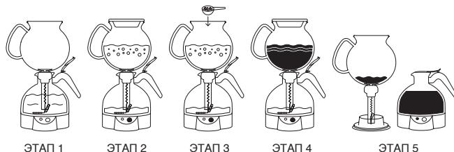
**Примечание:** Если кувшин (11) пуст, прибор, в целях безопасности не включится, и не даст нагревательному элементу работать без воды.
