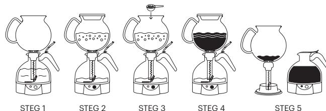
**Obs!** Om kannan (11) är tom kommer inte apparaten att slås på av säkerhetsskäl för att förhindra att värmeelementet körs när det är torrt.
